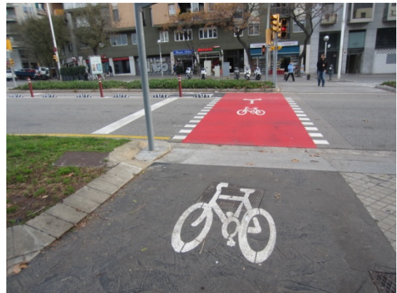
Imatge 2. Pas de bicicletes, segregat del de vianants.
